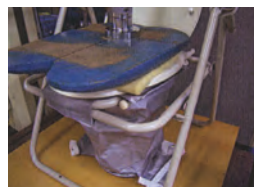
* トイレ座面強度検査 JIS S1203(1998) 2000N 異常なし
